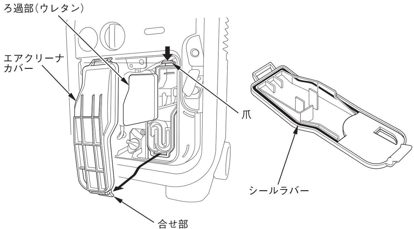
4. ろ過部(ウレタン)を洗い油で洗浄し、固くしぼってからエンジンオイル(ウルトラG 1または、ウルトラU汎用—SAE 10W-30等)に浸し、固くしぼります。
