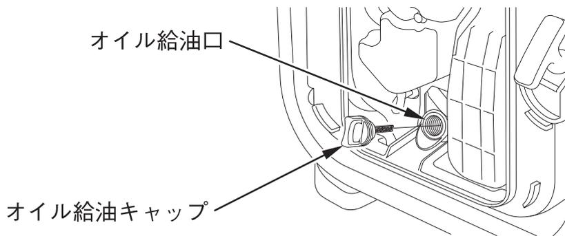
3. 本機を縦置き (12頁参照) にし、エンジンオイルを注入口の口元まで注入します。
