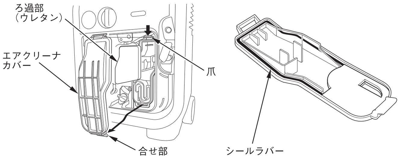
4. エアクリーナカバーに取付けられたシールラバーに損傷がないこと、また確実に取付けられていることを確認します。
